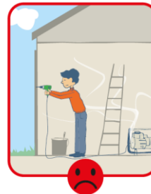
Groupe électrogène : à utiliser dehors
