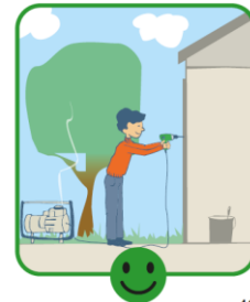
Groupe électrogène : à utiliser dehors
